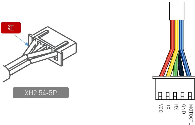
图表 2-5 RPLIDAR 电源接口定义示意图
