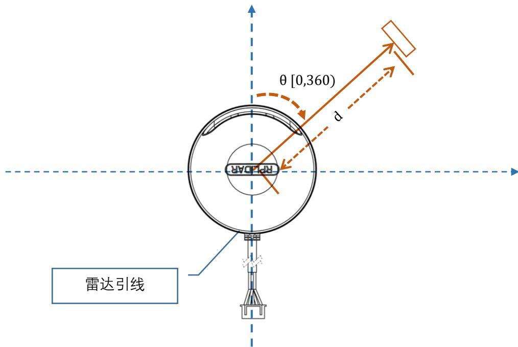
图表 2-4 RPLIDAR 扫描数据坐标系定义
