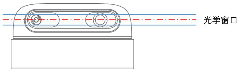
图表 2-3 RPLIDAR 光学窗口示意图
