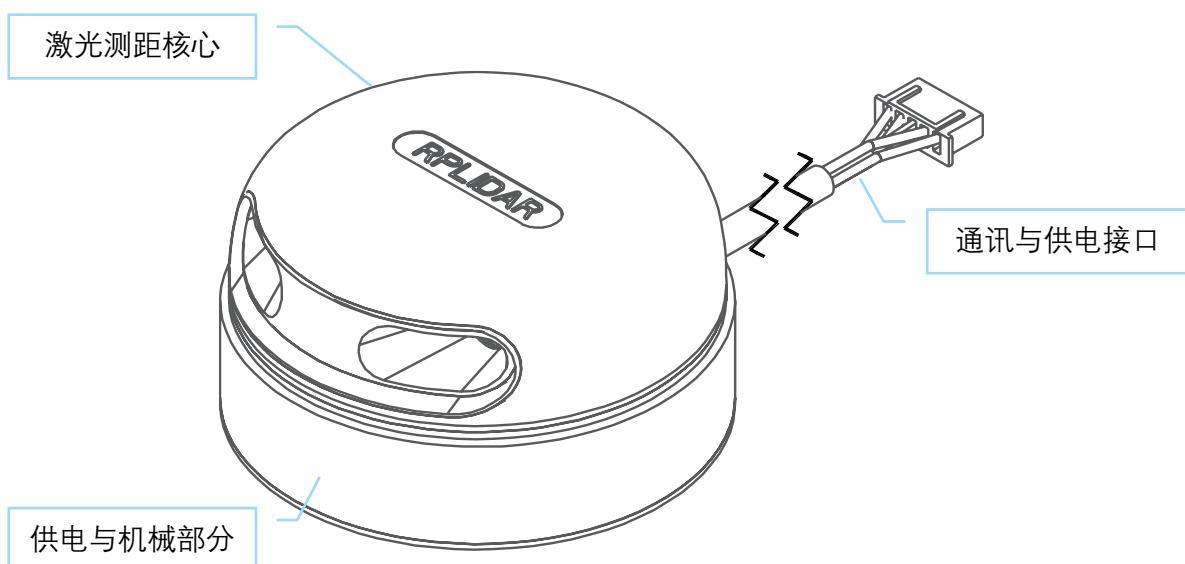
图表 1-1 RPLIDAR A3M1 系统构成示意图
