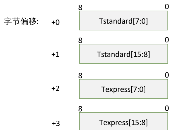
图表 4-24 激光测距用时获取请求对应的数据应答报文
