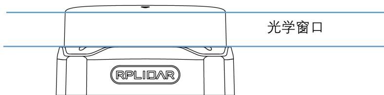
图表 2-3 RPLIDAR 光学窗口示意图
