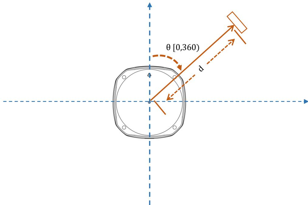
图表 2-4 RPLIDAR S2 扫描数据坐标系定义
