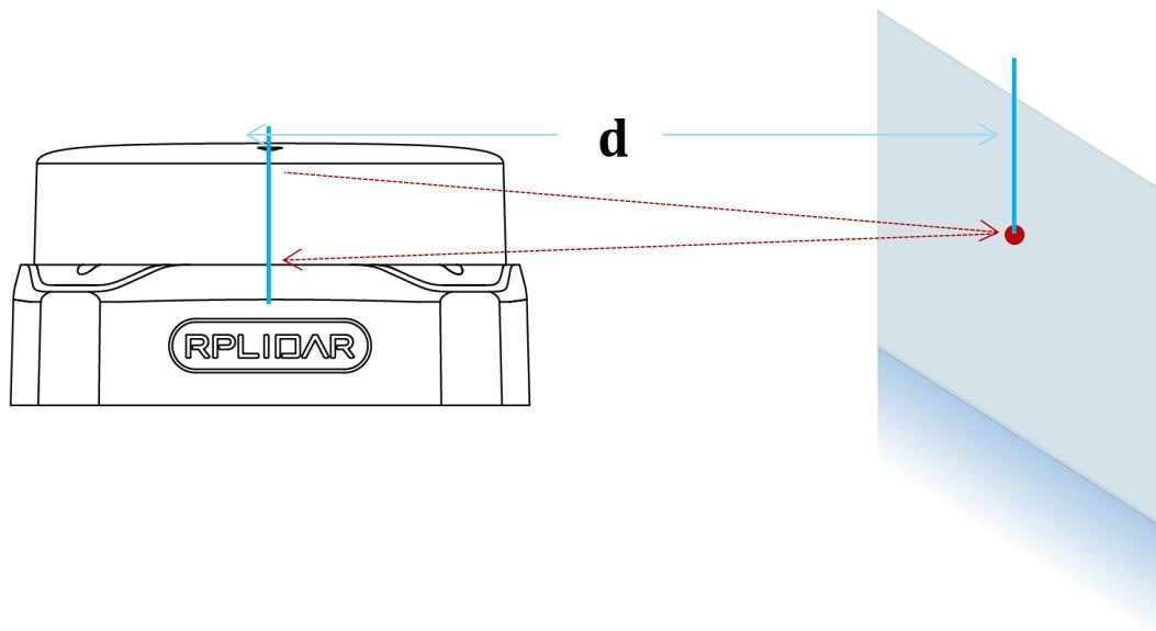
图表 1-2 RPLIDAR S2 工作原理示意图
