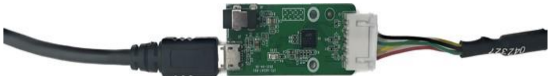
图表 2-2 连接 USB 转接器与 Micro-USB 实物图
